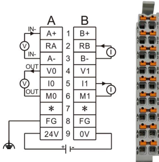
Fig.7.1-1 RP20-0202IV wiring diagram
