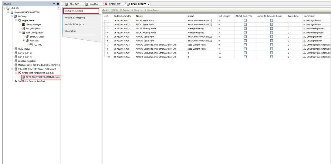
Fig.8.1.3-2 Configure startup parameters
