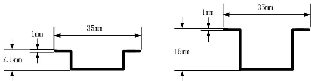
Fig.10.2-1 Standard DIN Rail
