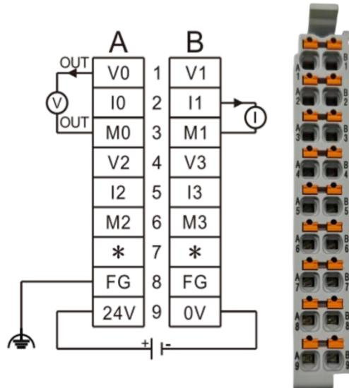
Fig.7.5-1 RP20-0004IV wiring diagram
